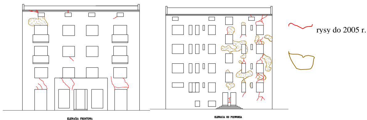
Rys. 3. Stan techniczny elewacji do roku 2005
