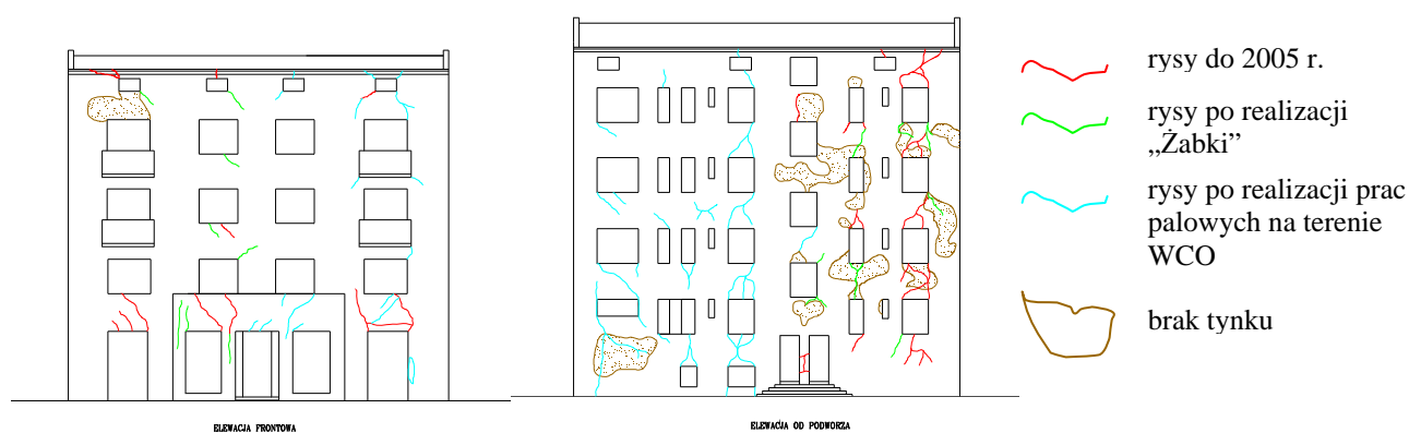
Rys. 5. Stan techniczny elewacji po wykonaniu prac modernizacyjnych w strefie sklepu Żabka i prac palowych na terenie WCO
