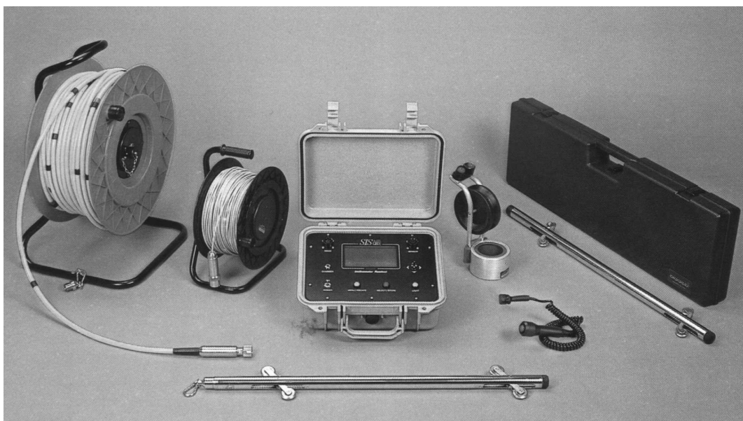
Rys. 2 Zestaw urządzeń do pomiarów inklinometrycznych – sonda SV200 i rejestrator C800U
