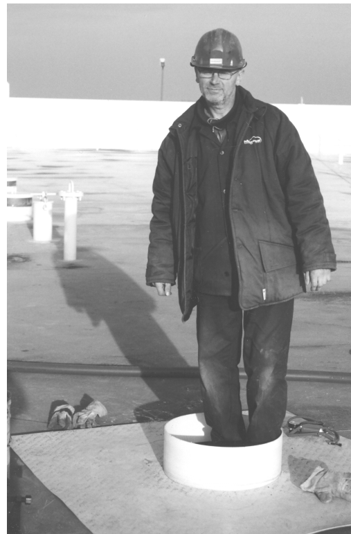
Rys. 10. Sprawdzenie wytrzymałości zamknięcia zaślepką
