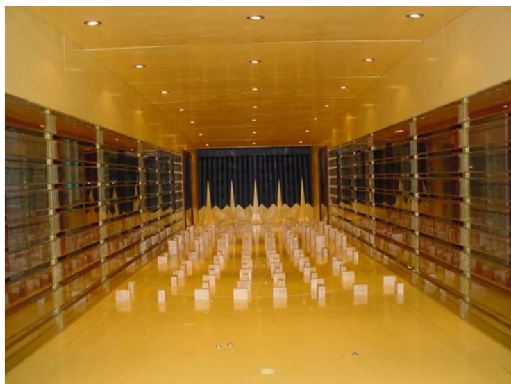
Rys.13. Wnętrze tunelu aerodynamicznego Politechniki Krakowskiej. Widoczne klocki i iglice służące do modelowania warstwy przyściennej. Po bokach ściany ażurowe.
