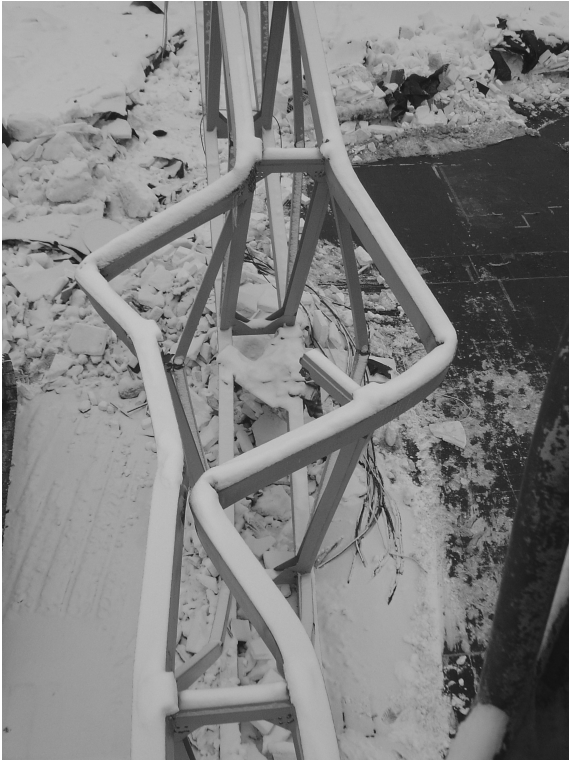
Rys. 13. Deformacje złamanych pasów podciągów a) K6 i b) K5
