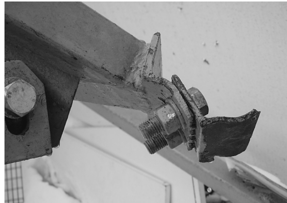
Rys. 17. Podstawowe formy zniszczenia połączeń zastrzałów z kratowymi płatwiami
