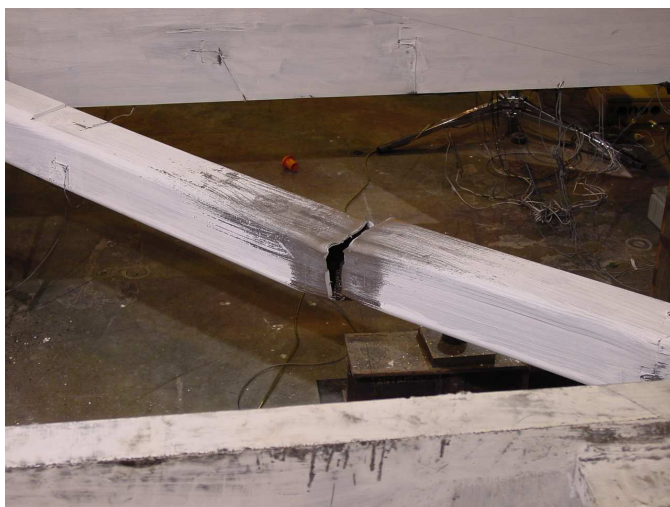
Rys. 4. Badania na University of California, Berkeley pokazały złamanie tężnika przy odkształceniach mniejszych od przewidywanych
