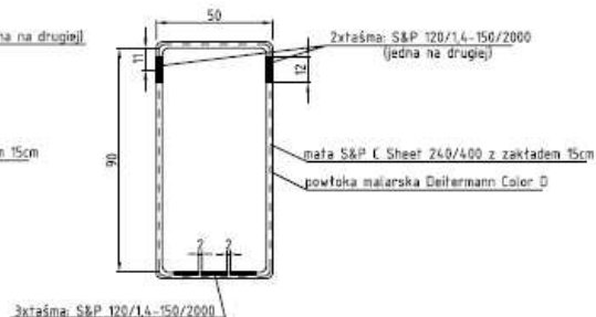
Przekrój B-B wzmocnienia rygla ramy żelbetowej skala: 1:20
