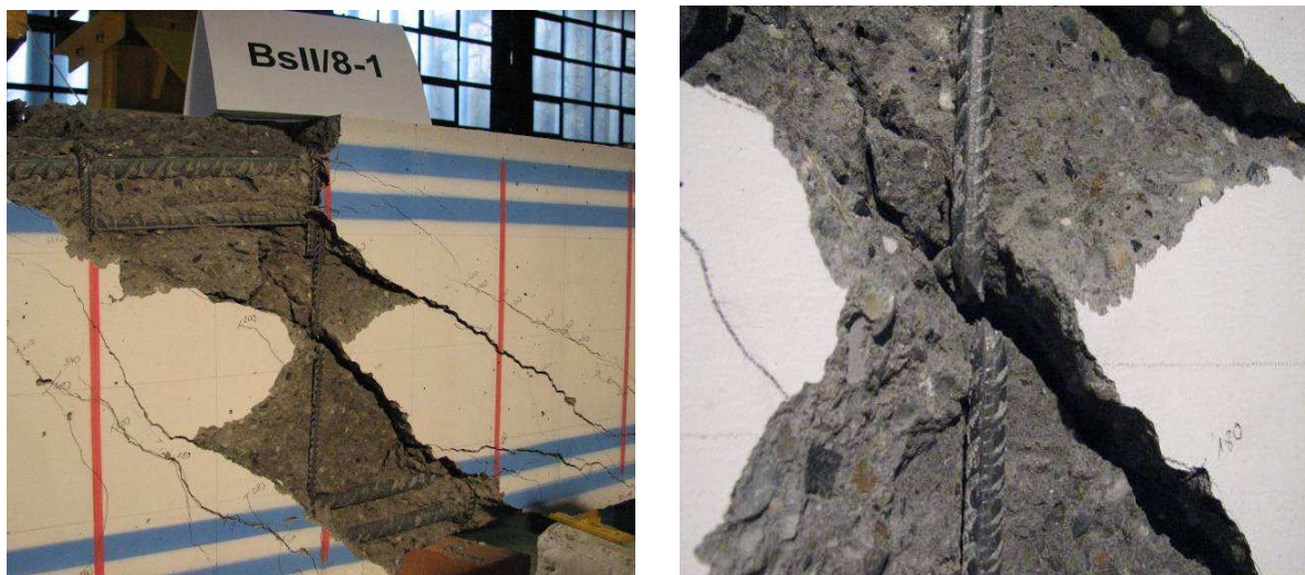
Rys.10. Zerwanie ramion strzemienia stal zimnowalcowana SII
