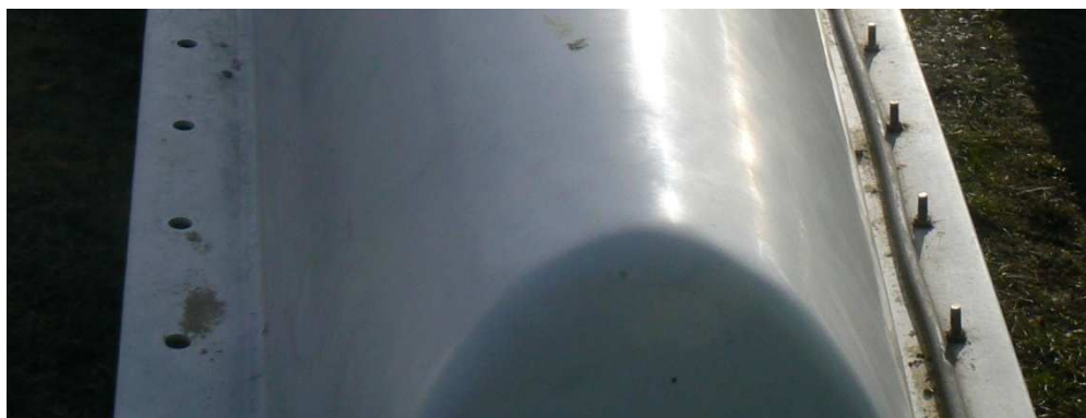
Rys. 6. Kołnierze połączeniowe lewy i prawy wewnętrznej łupiny w segmencie
