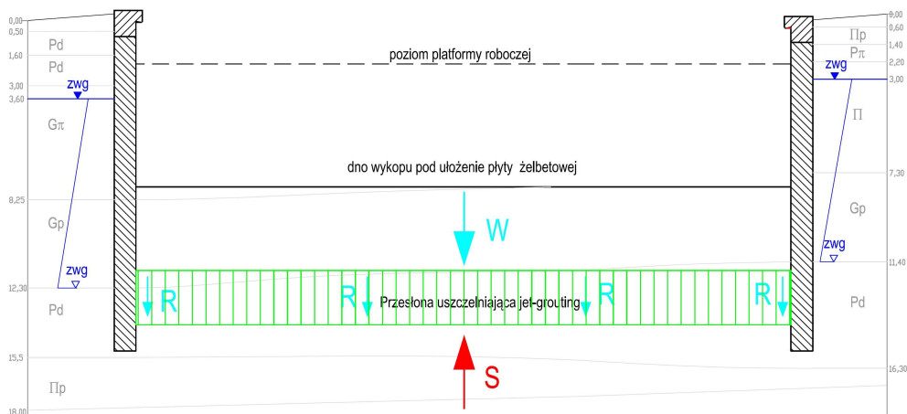
Rys. 5. Przykładowy przekrój poprzeczny ekranu uszczelniającego [1]
