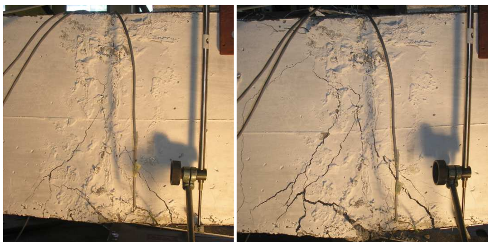
Rys. 5. Nieuszkodzona i uszkodzona strefa ściskana w belce pracującej na jednej taśmie C/PXBM
