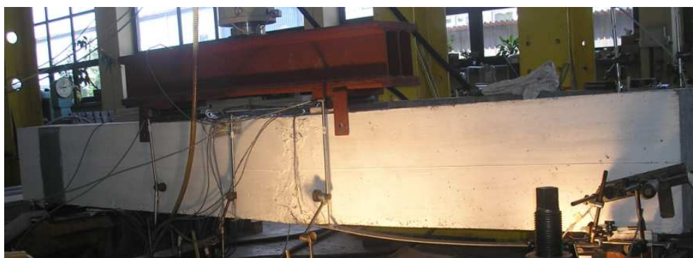
Rys. 4. Widok stanowiska badawczego z belką w trakcie badania (po oderwaniu obu taśm A i B)
