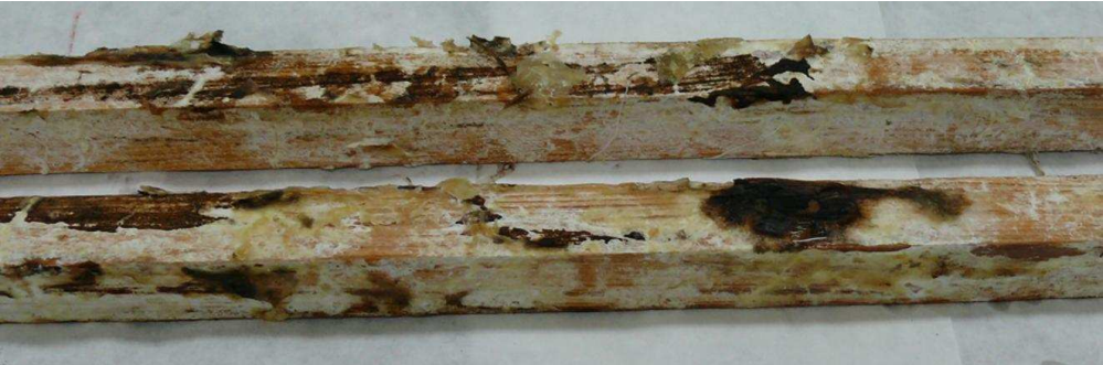
Rys. 2. Drewno zainfekowane przez grzyb w ciągu roku
