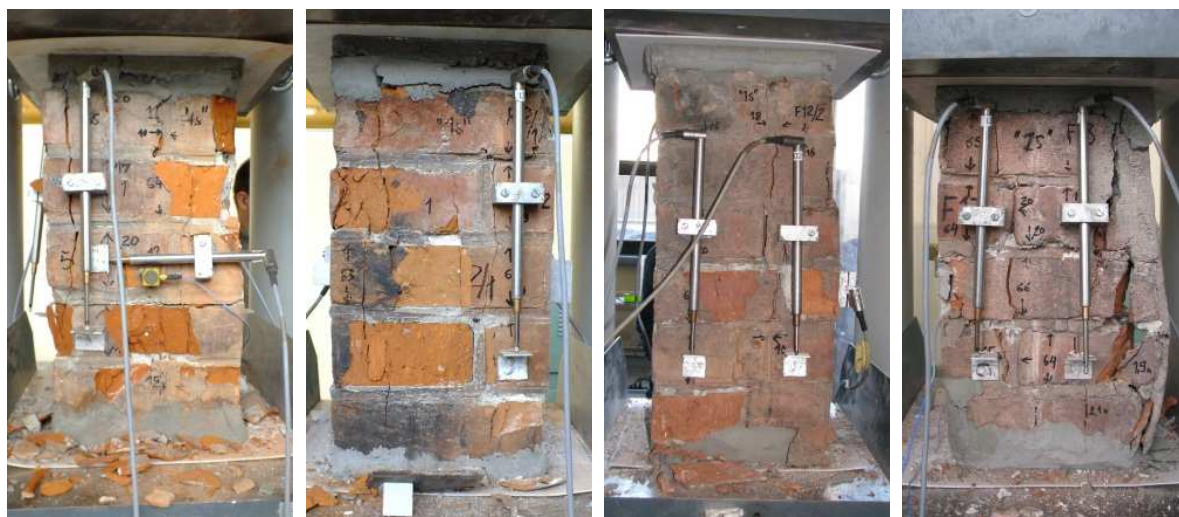
Rys. 4. Uszkodzenia filarek murowych przy wysokich poziomach obciążeń
