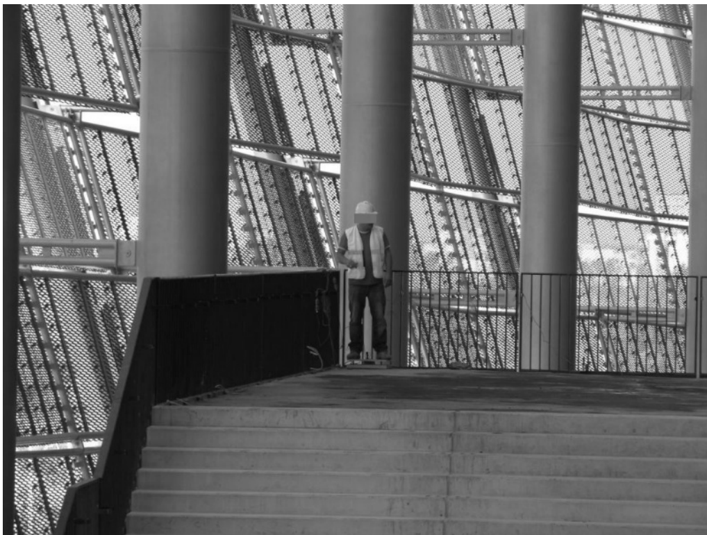
Rys. 6. Widok górnego spocznika w czasie próbnego obciążenia dynamicznego: podskoki 1 osoby na górnym spoczniku (fot. R. Czachowski)
