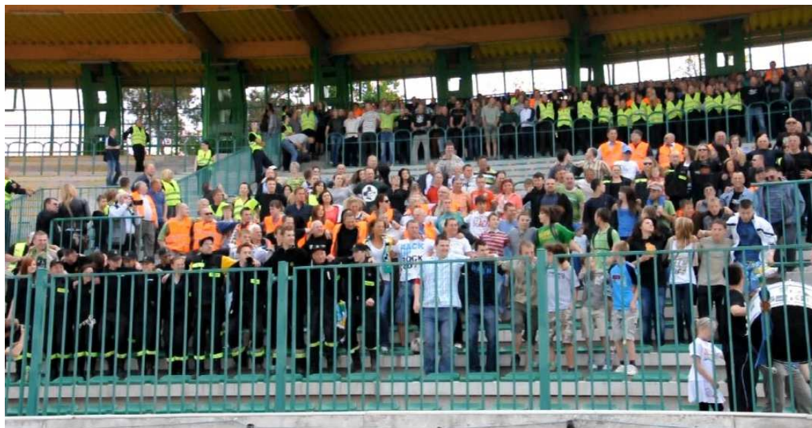
Rys. 3. Testy dynamiczne z udziałem kibiców (najniekorzystniejsze ustawienie, kibice tańczą „Labado” na dolnej i najwyższej, wspornikowej części trybuny)
