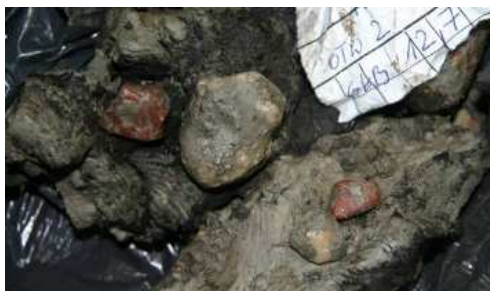
Rys. 4. Beton stwardzony w warstwie podłożowej węgla brunatnego w przestrzeni między palowej
