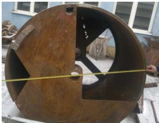
Rys. 3. Świder kadłubowy zastosowany do wiercenia pali
