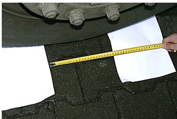
Rys. 3. Pomiar śladu odcisku koła autobusu podczas postoju
