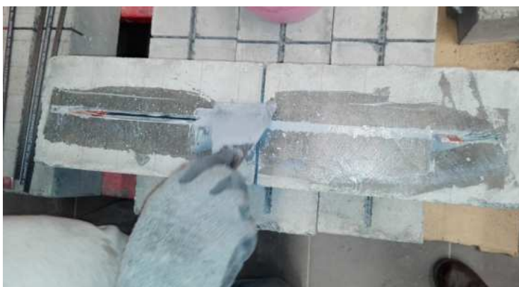
Rys. 5. Wklejanie taśmy w badany element
