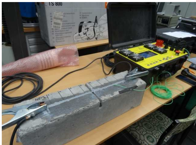
Rys. 1. Widok elementu badawczego z dołączonym urządzeniem grzewczym
