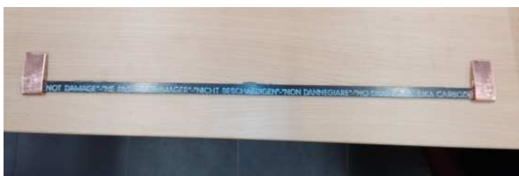
Rys. 4. Widok taśmy węglowej z miedzianymi płaskownikami
