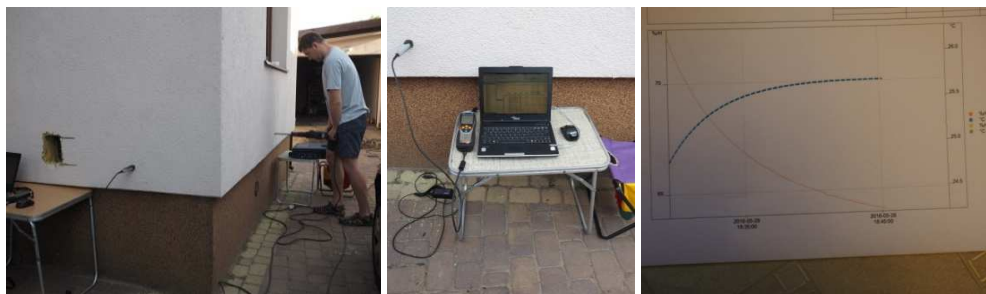
Rys. 2.1–2.3. Pomiary sondą wewnątrz ściany ( t – temperatury, H – wilgotności względnej powietrza)
