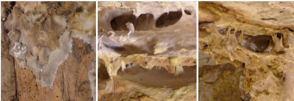
Rys. 4.1–4.3. Wygląd grzyba piwnicznego ( Coniophora puteana ) oraz ślady pożerowania szkodnika
